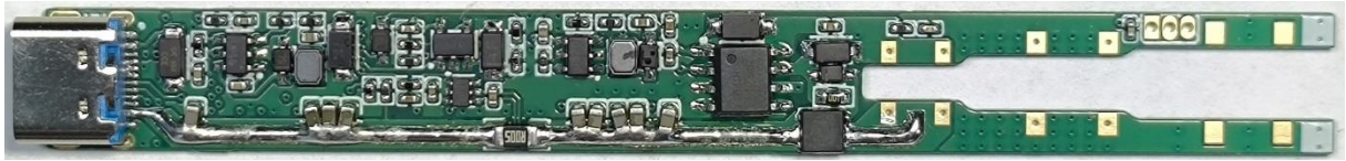
PCB-加热台焊接完成-部分连锡
